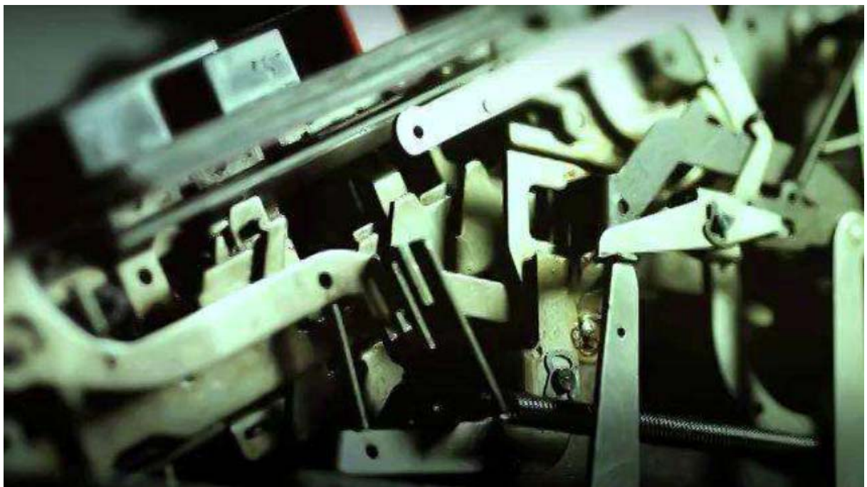
写真3 Divisumma (1947) の内部機構
